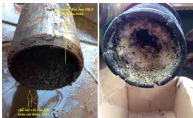
Hình 9. Sa lắng muối kết hợp cát trong ống khai thác giếng Thỏ Trắng.
